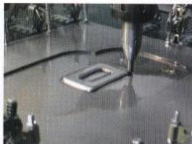
(ロ) ムービングツールによる塑性加工
