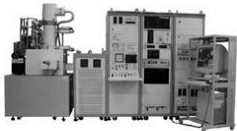
注目を集める超高精度電子ビーム描画装置
