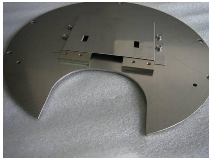
電子ビーム偏向用磁石（磁気回路）
